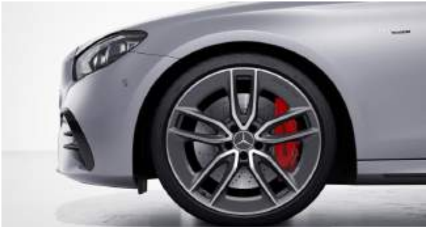
Llantas de aleación AMG de 20" y 5 radios color gris tántalo y pulidas a alto brillo, delante: 245/35 R20 ,detrás: 275/30 R20
