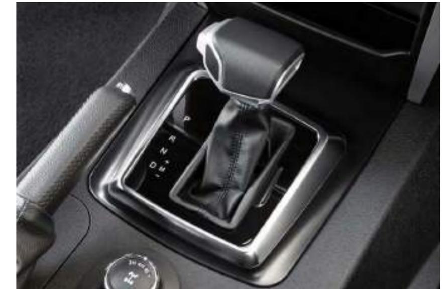
El modo de cambio manual permite controlar la transmisión automática con mayor precisión y usar la potencia de motor, simula el funcionamiento de la caja mecánica con incremento o disminución secuencial de la transmisión cuando la palanca está en la posición "+/-".
