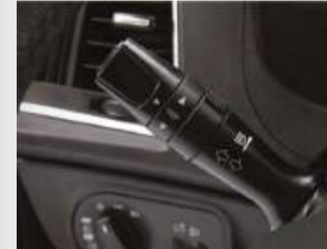
Mando izquierdo con indicador de las luces de dirección y control del computador de a bordo
