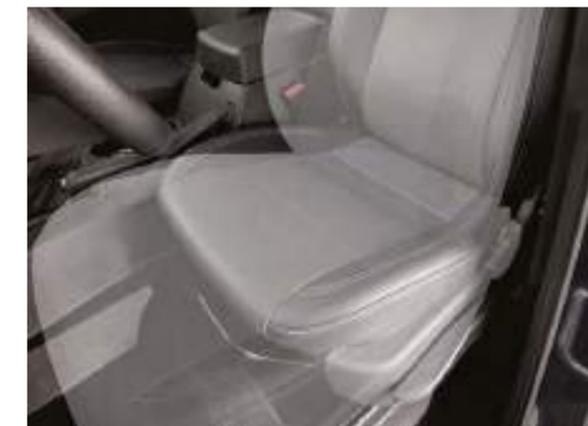
El ajuste del asiento del conductor incluye regulación de altura y del apoyo lumbar
