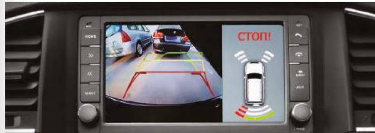
Al retroceder, se muestran en la pantalla a color la imagen de la cámara retrovisora con líneas dinámicas y el estado de funcionamiento de los sensores de aparcamiento traseros y delanteros
