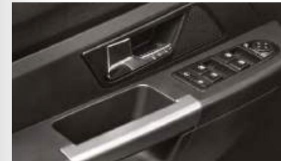
Control de elevación eléctrica y retrovisores exteriores en la puerta del conductor
