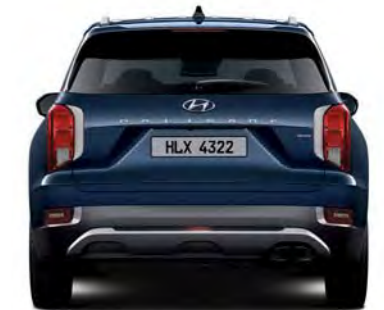
Banda de rodadura 1,716 Ancho general 1,975
