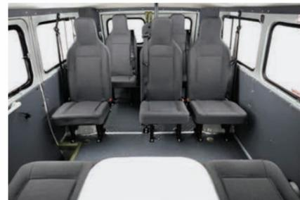
El diseño del interior de la cabina para nueve asientos prevé la presencia de una mesita plegable
