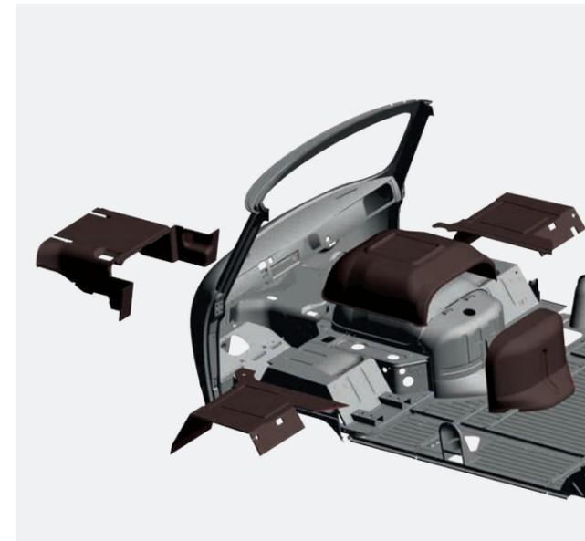
Gracias al aislamiento mejorado acústico del motor y al aislamiento contra las vibraciones de la carrocería se ha logrado un ambiente cómodo en el vehículo. El aislamiento acústico con superficie de lanilla mejora la acústica y el acabado interior de la cabina.
