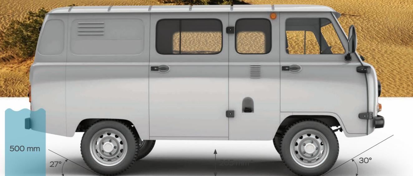
\* Altura mínima del chasis – distancia del suelo al cárter del eje.
