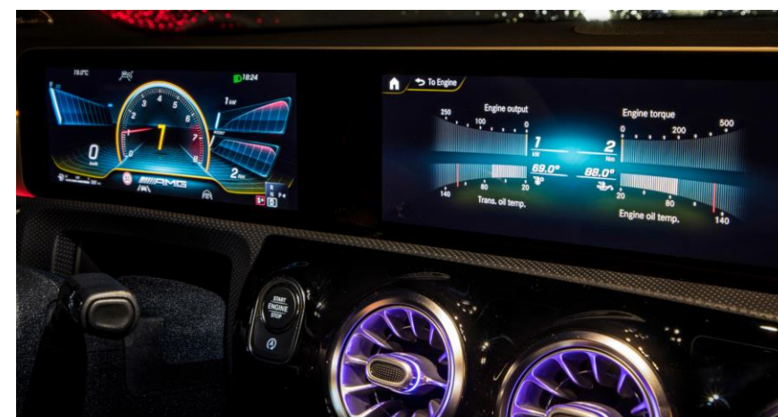
Pantallas de 10,25" para cuadro de instrumentos y sistema de infoentretenimiento MBUX
