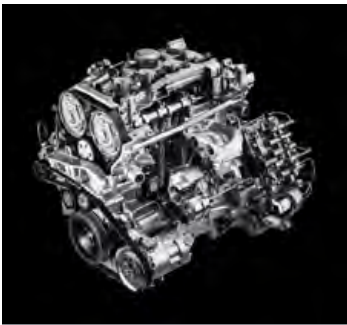
El motor turbo 1,750 totalmente de aluminio con inyección directa del 4C.
