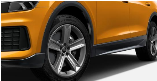
Llantas de aleación de aluminio tamaño 10Jx20, diseño de 5 brazos, con neumáticos 285/45
